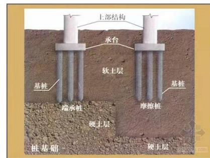
图 1 桩基础施工剖面图
